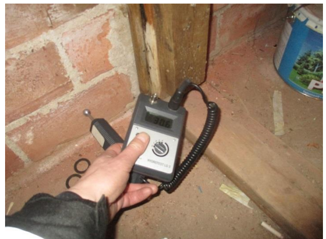
35.- 36. Kellarin kosteusmittaus, lattia ja seinän alaosa ovat kuivia
