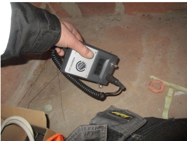
35.- 36. Kellarin kosteusmittaus, lattia ja seinän alaosa ovat kuivia
